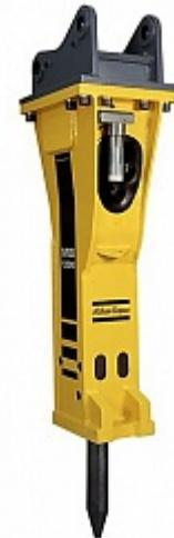
Гидромолоты MB среднего класса являются чрезвычайно эффективным оборудованием. Гидромолоты приводятся в действие с помощью масла и газа, что уменьшает их зависимость от гидравлической системы. 70% энергии удара образуется газом в поршневой камере и только 30% – маслом гидравлической системы носителя. Поступающая энергия оптимизируется и усиливается с помощью внутреннего регулирующего клапана.
